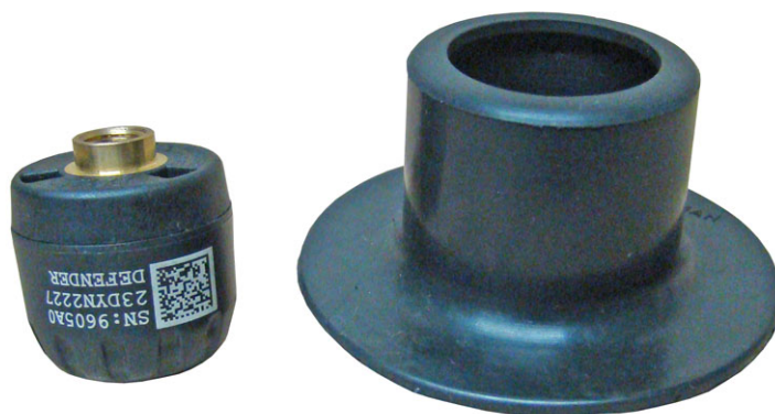
Рисунок 3.5.3 – Датчик шины и карман установки
