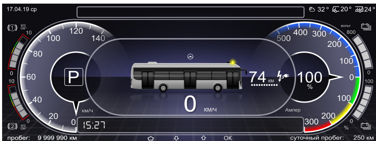
Рисунок 4.1.28 – Индикация включенного проблескового маячка
