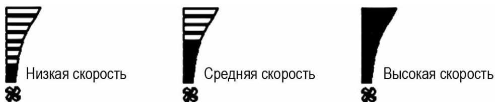
Рисунок 4.2.16. Индикация скорости вращения вентилятора
