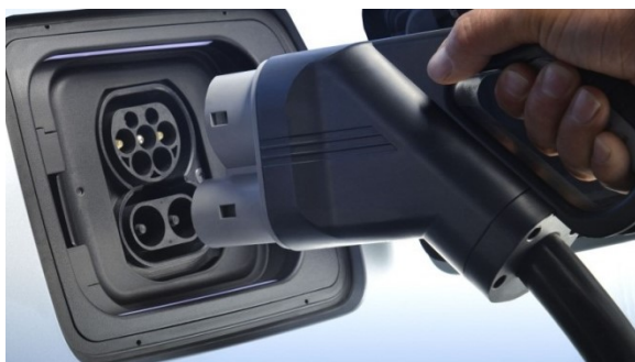
Рисунок 4.2.9 – Подключение зарядного пистолета
